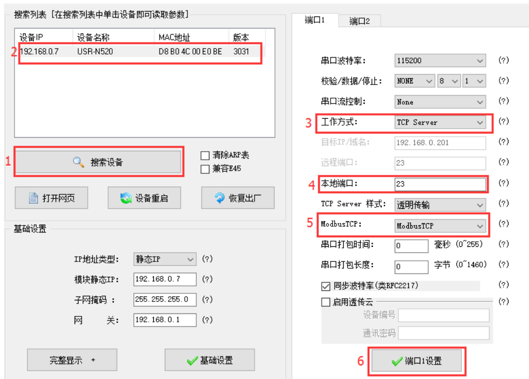
图40 Modbusrtu 转 Modbus tcp
